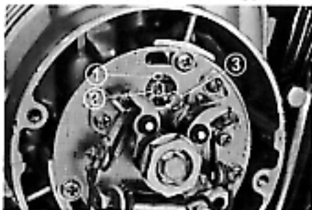
(1) Index mark (2) "T" mark (3) 1.4 cylinder mark
